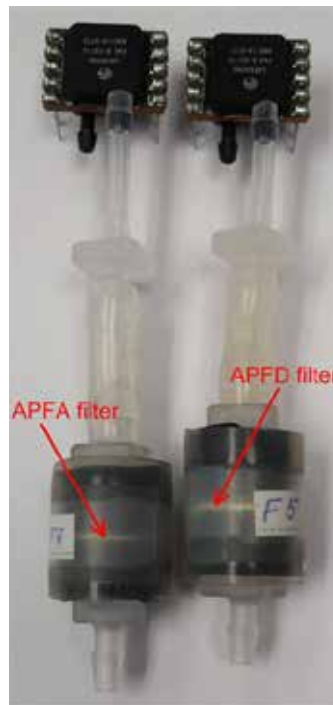
Abb. 16 An Sensoren angeschlossene Filter in Kartuschen
