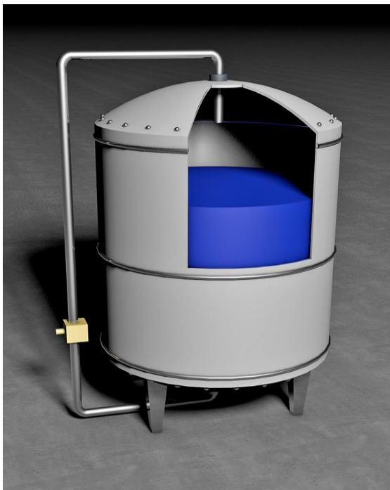
Abbildung 6: Füllstandmessung in geschlossenen Tanks
