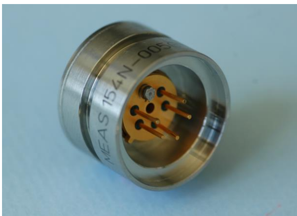
Abbildung 6: Ansicht Absolutdruck-Sensor mit Ölvorlage (Rückseite)
